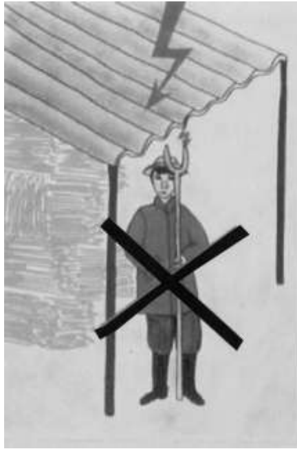
شکل ۴- نامناسب بودن سازه‌های فلزی در زمانی که به سامانه زمین متصل نباشد
